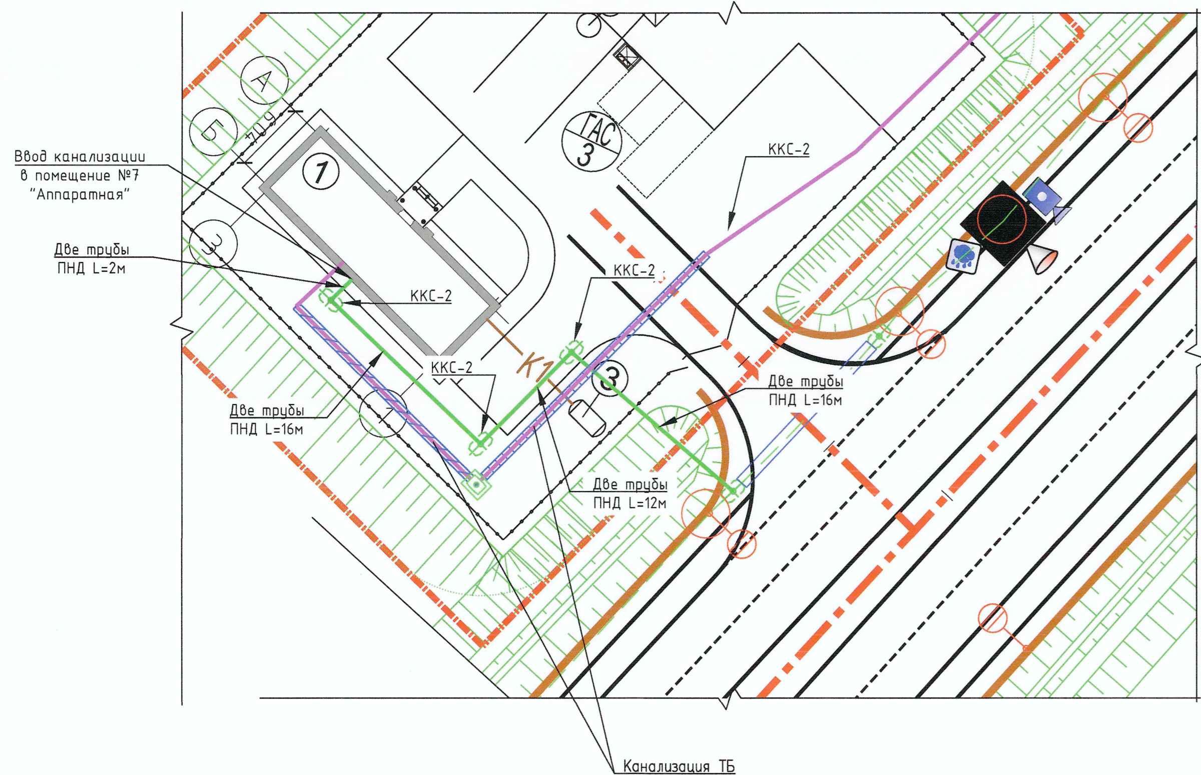
Фрагмент плана ввода ВОЛС в здание ПУТБ
