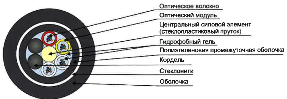
Рисунок 05. Конструкция кабеля марки ДПТс-П-08У (1х8)-6 кН
